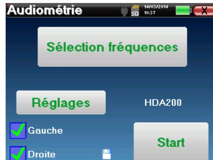
Cliquez sur «Sélection fréquences» afin de préconfigurer les fréquences à parcourir pendant le test. Une fois les fréquences choisies, cliquez sur «OK» pour valider.
