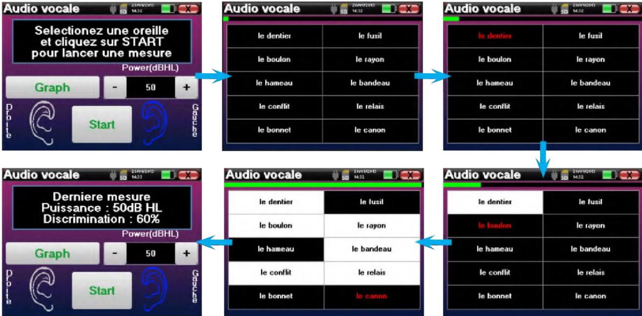
Une fois la liste de mots terminée, l'appareil revient sur la fenêtre de départ. Vous pouvez changer la puissance de stimulation en fonction du score du test précédent avant de relancer un nouveau point. Le bouton **Graph** permet de basculer entre le graphique et la réalisation d'un point.
